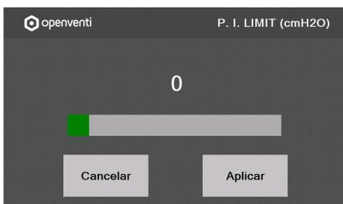
**LIMITS.** Permite configurar la Presión Inspiratoria Máxima (PIMax). Para este dispositivo la escala es de 0 a 80.
